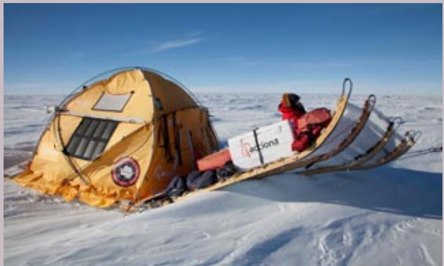
El vehículo es capaz de navegar sobre hielo impulsado por cometas y energía solar, sin combustibles fósiles.
