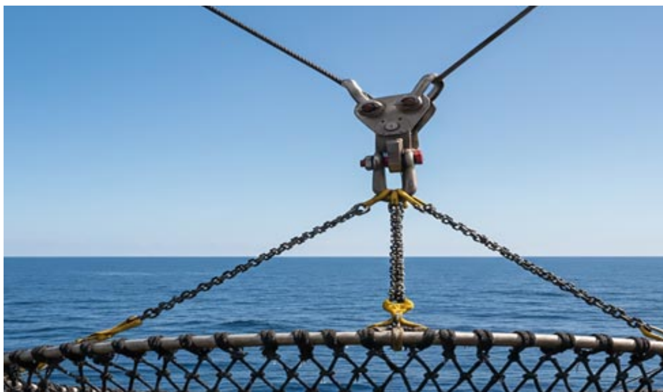
El Salabardo Inteligente es un sistema de pesaje integrado en la pasteca que permite conocer con exactitud el peso de las capturas durante la maniobra de izado
